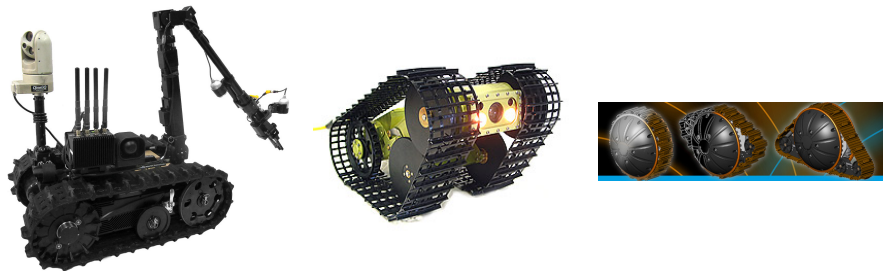
FIGURE 12 – Trois robots à chenilles, de gauche à droite : le TALON de QinetiQ à géométrie fixe, le VGTV d'Inuktun à chenilles non déformables et les chenilles déformables du Viper Robot de Galileo.
